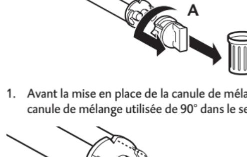
1. Avant la mise en place de la canule de mélange, tournez le bouchon [A] ou la canule de mélange utilisée de 90° dans le sens horaire et jetez-le/la.
