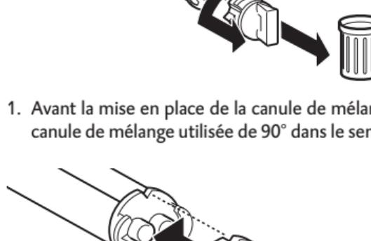
1. Avant la mise en place de la canule de mélange, tourner le bouchon [A] ou la canule de mélange utilisée de 90° dans le sens horaire et le/la jeter.
